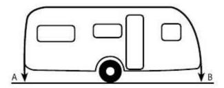
Primero nivele su caravana y fije la altura deseada. Con la caravana sobre una superficie plana, mida el contorno de la guía más su prolongación hasta el suelo por ambos lados, como en el siguiente gráfico. Puede utilizar una cuerda o una cinta métrica.Con la medida de A hasta B, obtendrá el perímetro de su caravana: a partir de aquí busque en la tabla de abajo y hallará la talla que le corresponde.
